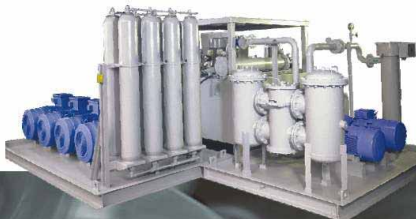
Ölversorgungsanlage WS 5500 S 4x TAP 60-200/200 D CO 01 Behälterinhalt 5500 l Förderstrom 180 dm 3 /min Druck 100 bar
