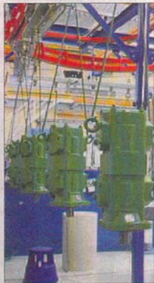
In einer hochmodernen Takt-Lackieranlage mit Kettenförderer werden die Pumpengehäuse von Rickmeier lackiert. (Bilder: Horst Hassel)
